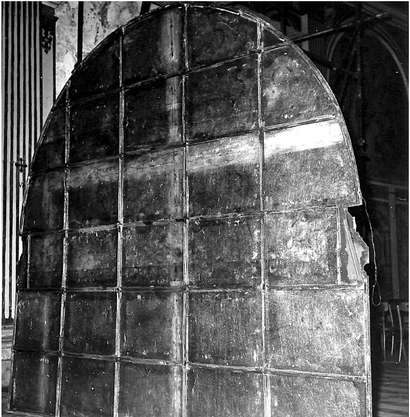
Certosa di Milano, particolare del telaio progettato dal prof. Ottemi della Rotta, in collaborazione con i fratelli Colli, a sostegno del dipinto della VI lunetta affrescata da Daniele Crespi strappata dalla parete nel 1968.
