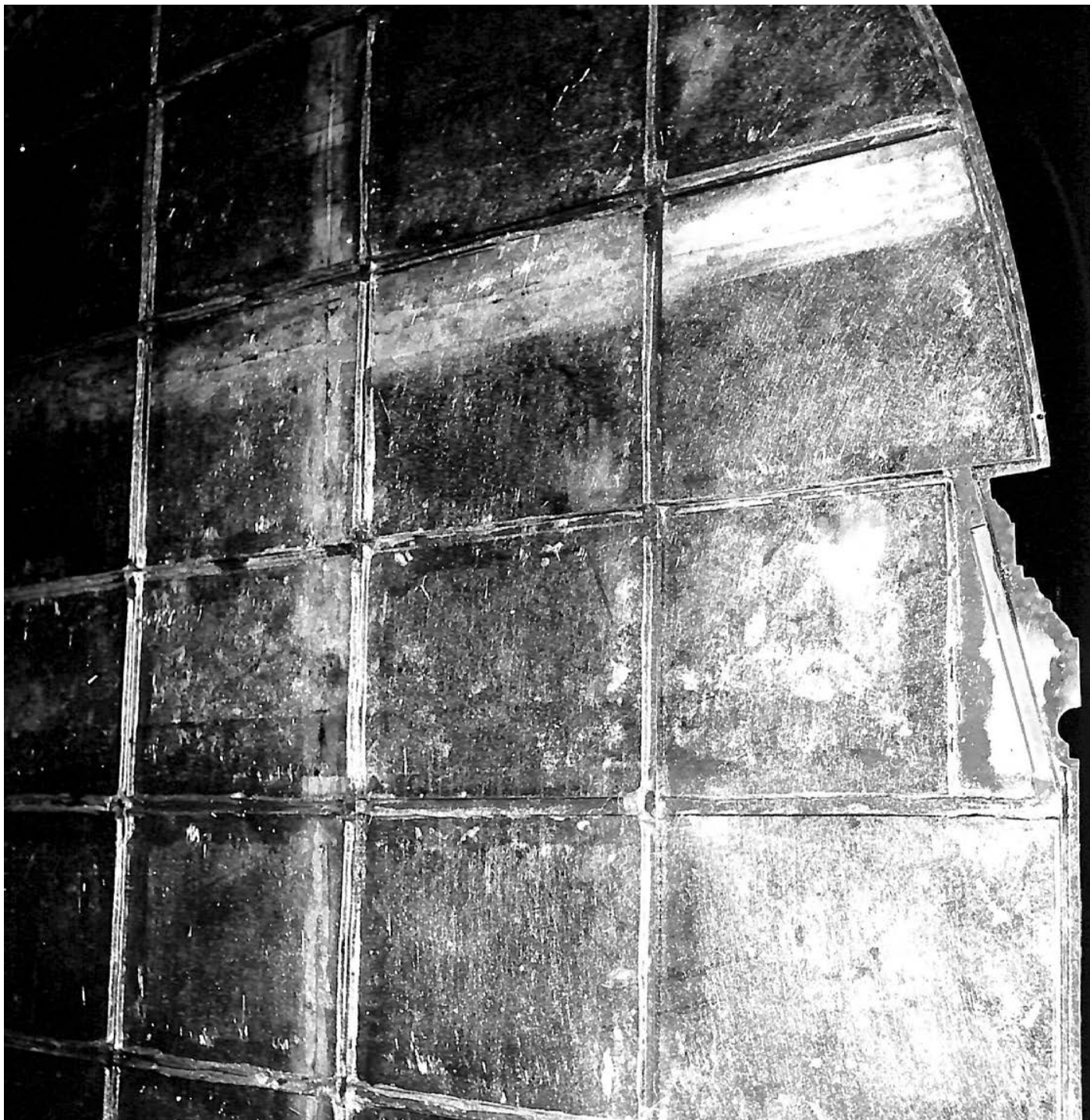
Certosa di Milano, particolare del telaio metallico dell'affresco della VI lunetta dopo lo strappo e il restauro della pellicola pittorica eseguiti dal prof. Ottemi della Rotta. L'opera di Daniele Crespi è pronta per essere ricollocata nella parete settentrionale della chiesa.
